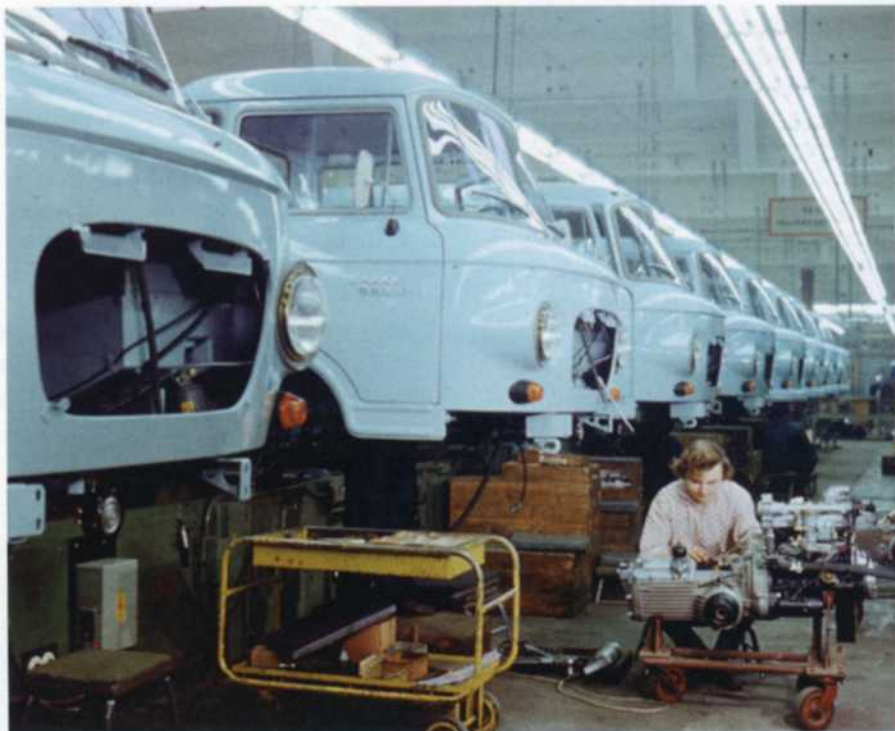
Gefertigt wurde, aber zu wenig, um dem Bedarf gerecht zu werden: Montage des Barkas B1000 in Karl-Marx-Stadt (1974).
